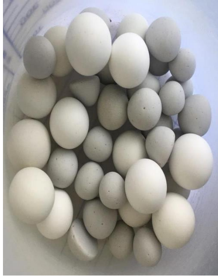
Figura 6: Bolas de Cerâmica utilizadas para moagem. Fonte: Acervo da própria autora
